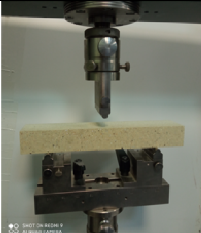
Rys. 1. Obszar roboczy maszyny wytrzymałościowej z przyrządem do trójpunktowego zginania próbek.
